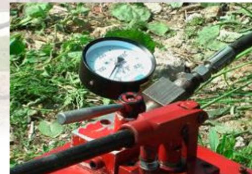
Это является гарантией того, что свайный фундамент справится с излишней нагрузкой при любых непредвиденных обстоятельствах (стихия, утяжеление конструкции). Специально для проведения испытаний собирается установка, состоящая из системы балок и упоров, гидравлического домкрата с манометром, анкерной сваи и прогибомеров.
