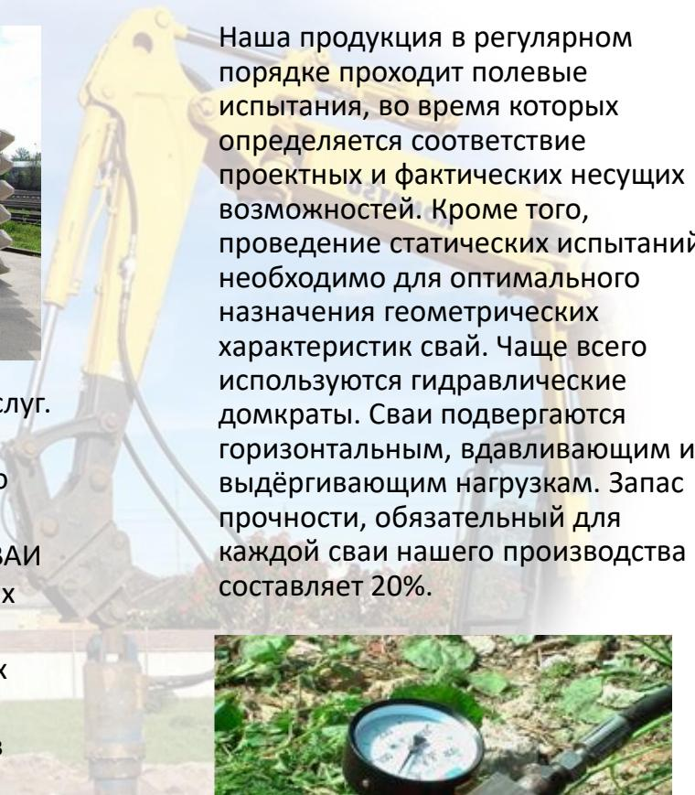
Наша продукция в регулярном порядке проходит полевые испытания, во время которых определяется соответствие проектных и фактических несущих возможностей. Кроме того, проведение статических испытаний необходимо для оптимального назначения геометрических характеристик свай. Чаще всего используются гидравлические домкраты. Сваи подвергаются горизонтальным, вдавливающим и выдёргивающим нагрузкам. Запас прочности, обязательный для каждой сваи нашего производства составляет 20%.
